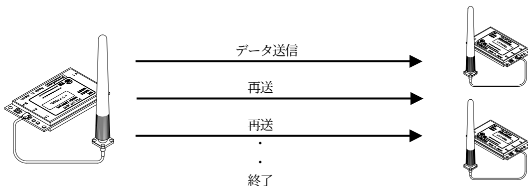
図 15：同報通信のプロトコル
