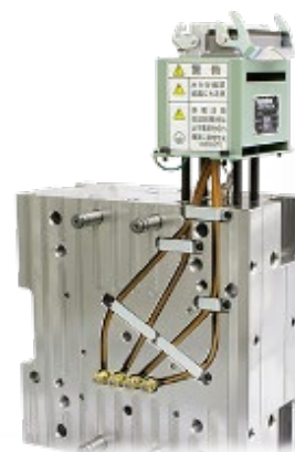
廃棄樹脂量削減 (ホットランナシステム)
