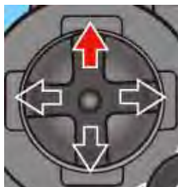
Fig. 3.5 上方向ボタンが押された状態
